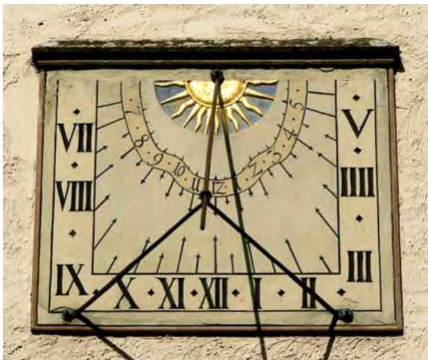
Vertikale Sonnenuhr mit Polstab, Süd-Wand, Stabschatten links drehend
