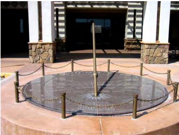
Horizontale Sonnenuhr mit Knoten als Nodus auf dem Polstab: strahlenförmige Stundenlinien und hyperbelförmige Tagesbahnen
